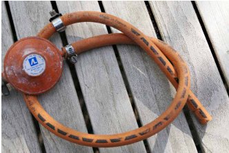
Unzulässiger Regler, verbotener Weise mit Schlauchschellen an unzulässigem Schlauch
